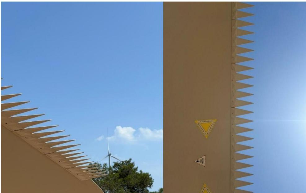
Figure 15 : Photographies de serrations (peigne acoustique) en bout de pale
